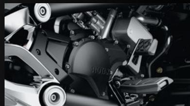
Le moteur Rotax 1330 ACE, qui compte trois cylindres en ligne pour une bonne reprise à chaque rapport et 40 % en plus de couple à bas régime, produit un échappement bien spécifique. L'option moteur Rotax 998 cm<sup>3</sup> à deux cylindres en V offre la reprise, le couple et la puissance nécessaires à toutes les sorties sur route.
